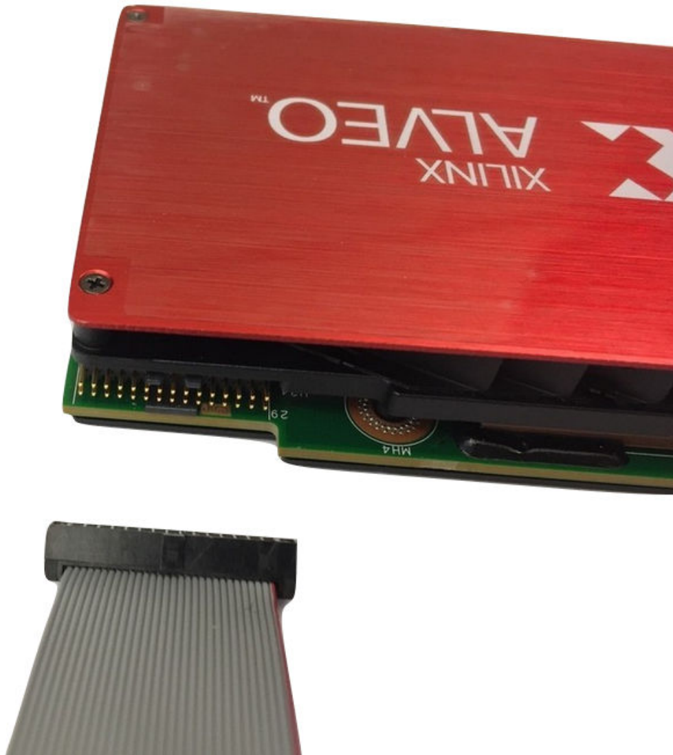
図 4: リボン ケーブルの Alveo メンテナンス コネクタ ポートへの接続
