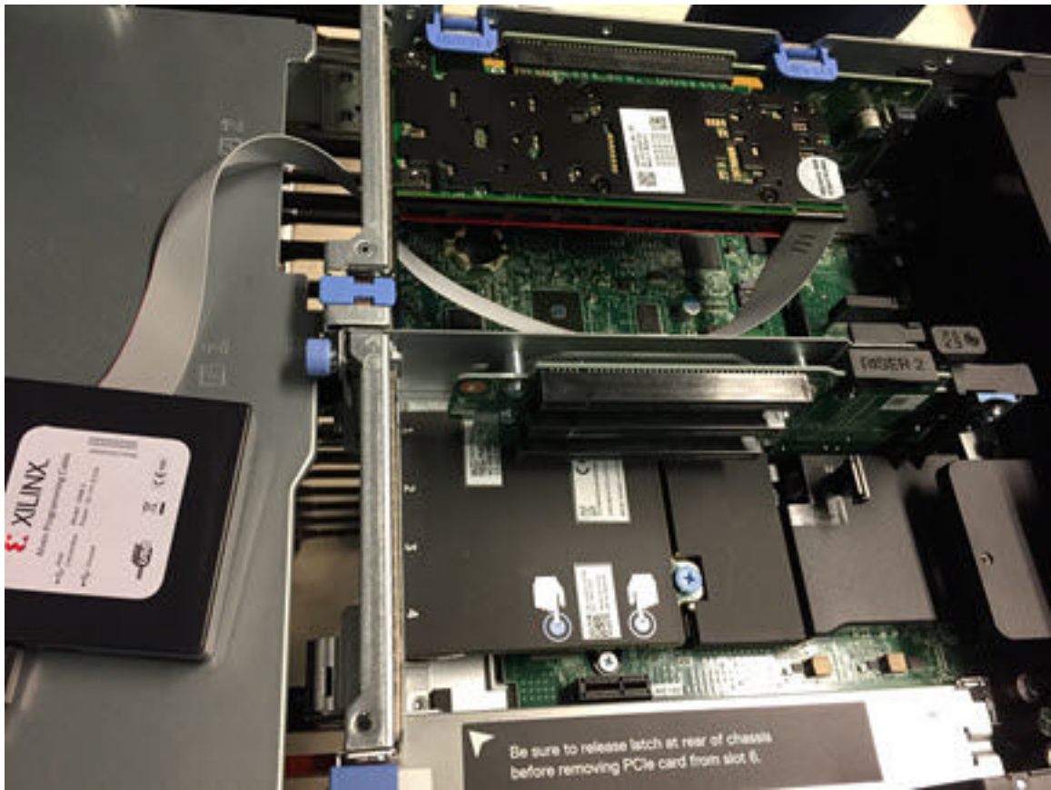
図 6: 設置した Alveo データセンター アクセラレータ カードの Alveo プログラム モジュールへの接続 - 側面図
