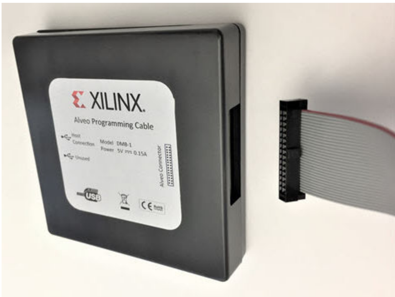
図 3: リボンケーブルのデバッグ コネクタへの接続
