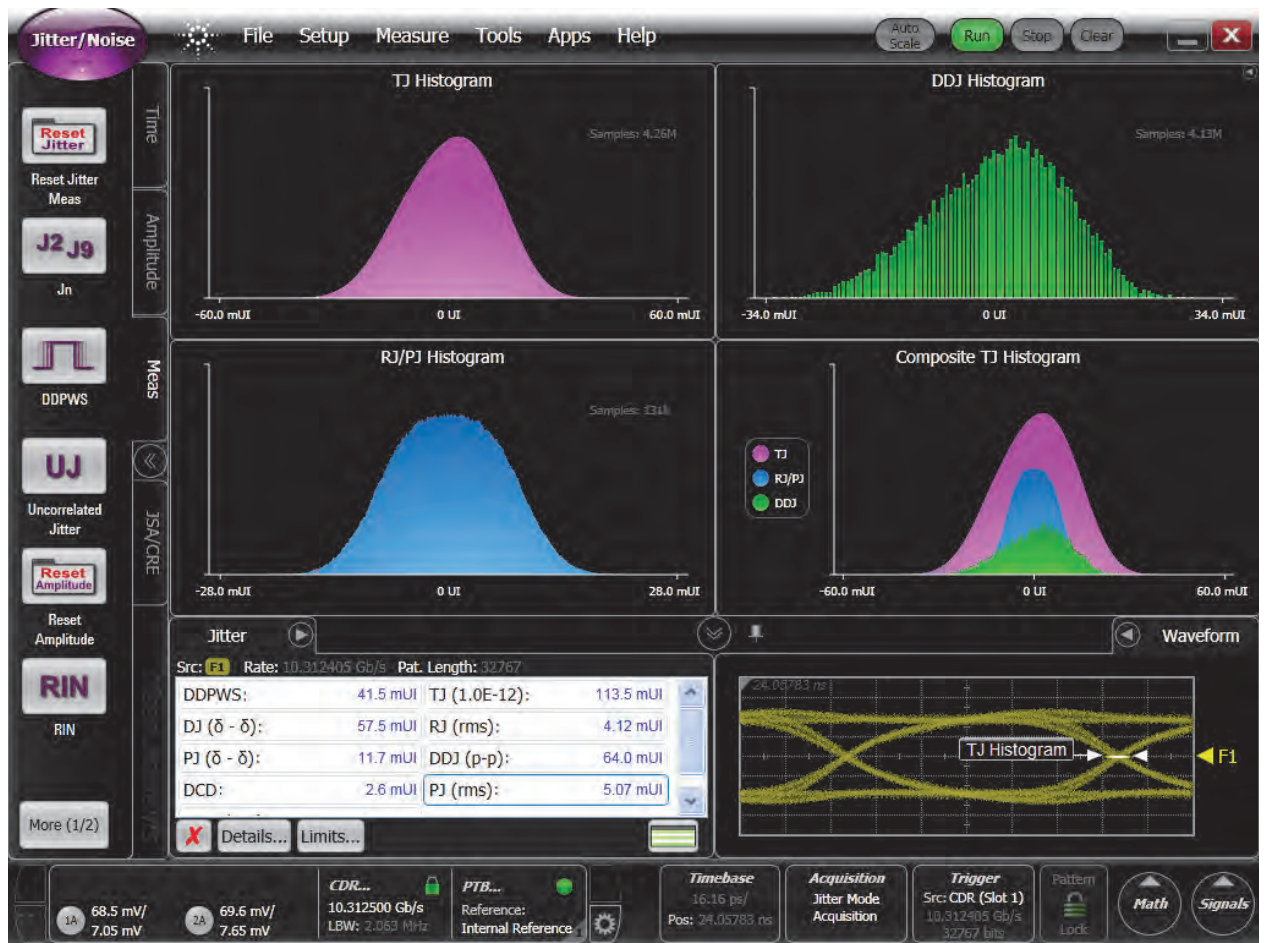
図 11: 10.3125Gb/s の出力とジッター分解
